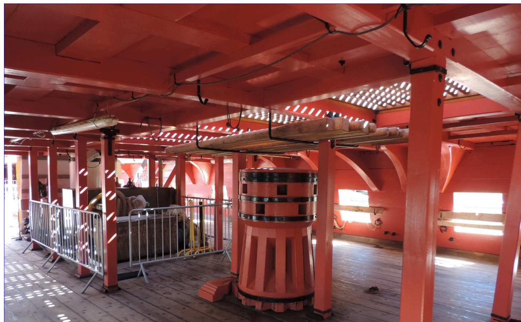
Cabestan servant aux manœuvres et notamment au relevage de l'ancre
